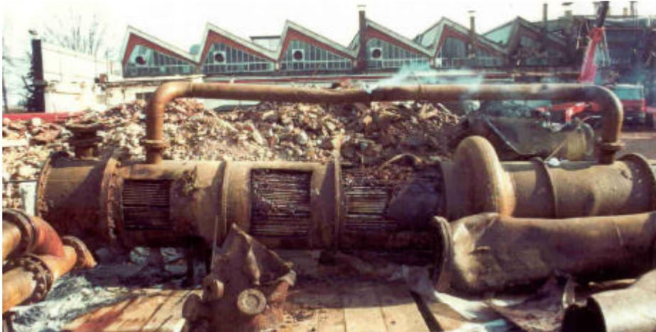
Foto 6.2 – Il condensatore dei vapori di testa
