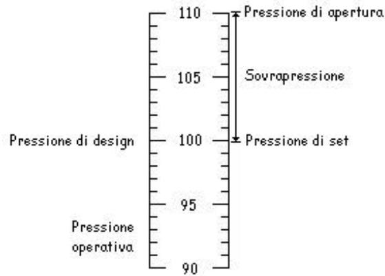
Fig. 9.9 - Pressioni che caratterizzano una valvola di sicurezza a molla, British Standard 5500.
